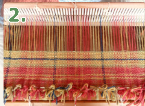
2. 緯糸はゆとりをもって縮絨を楽しむため目が詰まらないように打ち込みます。
